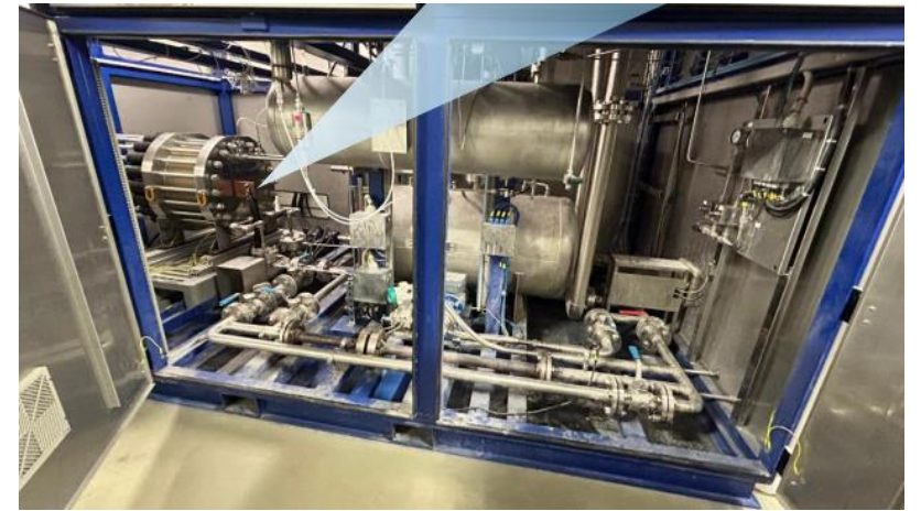
Kliendi katse-stack (30kW) pooltööstuslikul testimisel
